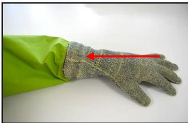
Schnittschutzhandschuhe über die Anzughandschuhe und die im CSA befestigten Steifrings ← ziehen.
