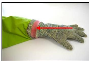
Die Schnittschutzhandschuhe mit den kleinen Gummiringen (rot) in der Nut des Steifrings fixieren.
