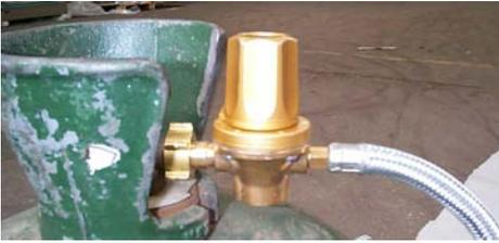
Stellen Sie die Gasflasche in ausreichender Entfernung zum Brandbecken auf; nutzen Sie hierzu die gesamte Länge des ungekrümmten Schlauchs aus.
